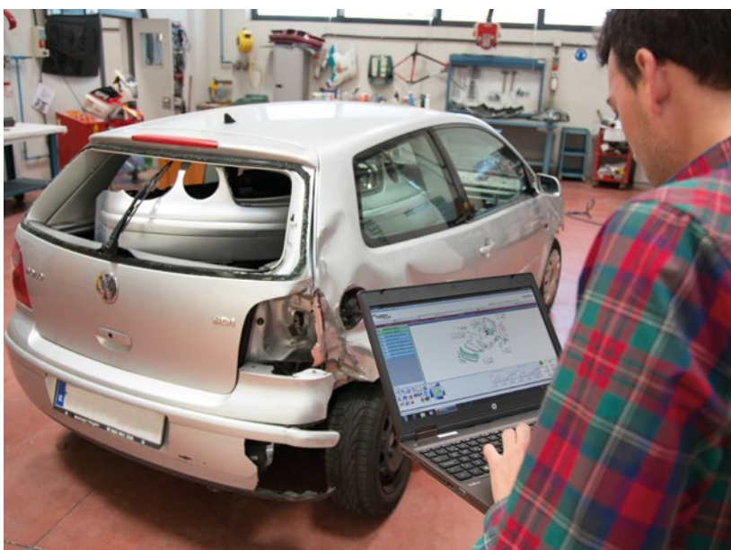
► Identificación de las piezas a sustituir
